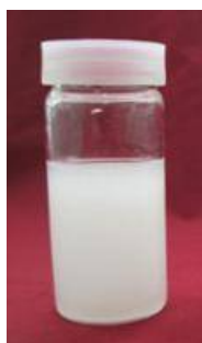
Gambar 1. Pulp akasia terputihkan setelah di refiner 30x
