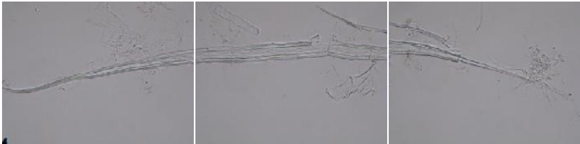
Gambar 8. Pulp akasia diputihkan setelah refiner 30x sirkulasi dan ultraturrax 60 menit, pembesaran 400x
