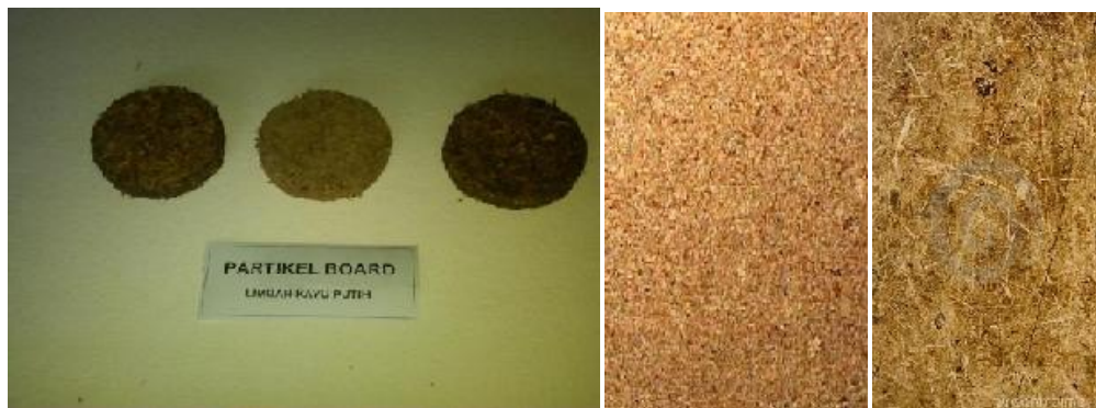
Gambar 5. Contoh papan partikel limbah kayu putih
