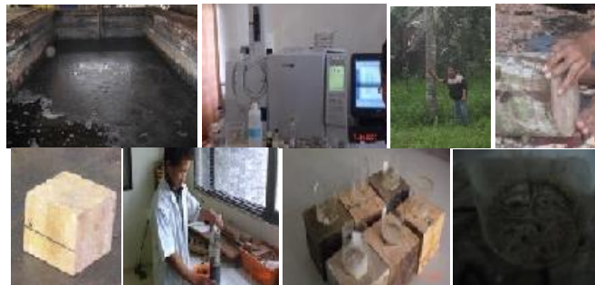
Gambar 1. Kiri ke kanan: > limbah air rebusan kayu jati, pengujian menggunakan GCMS, pohon sengon contoh uji, pembuatan sampel kayu, > sampel berukuran 5 x 5 x 5 cm, pengawetan dengan rendaman dingin, penutupan permukaan dengan lilin dan kaca, pengumpanan terhadap rayap kayu kering
