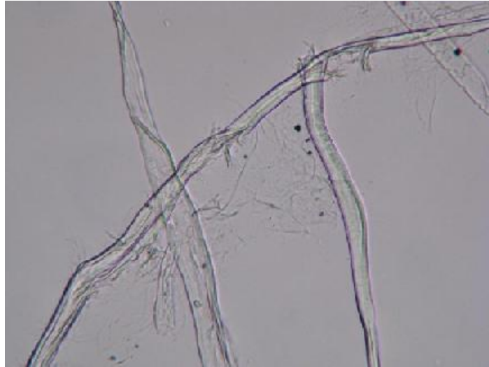
Gambar 7. Pulp akasia diputihkan setelah refiner 30x sirkulasi dan ultrasonik 60 menit, pembesaran 400x
