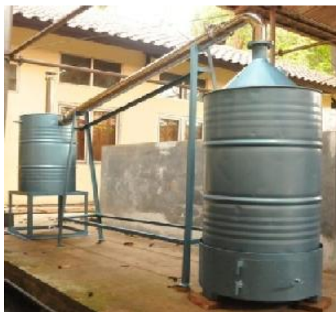
Gambar 1. Tungku drum modifikasi yang dilengkapi pipa pengalir dan pipa pendingin asap/ tungku drum modifikasi generasi 3
