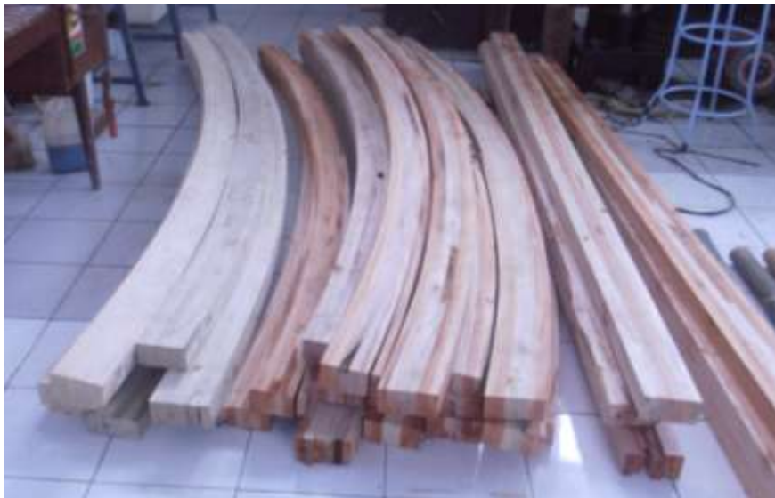
(h) Hasil pelengkungan glulam kayu jabon dan campuran jabon mahoni
