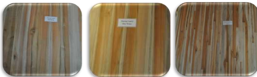
Gambar 1. Produk akhir pemanfaatan kayu jati-JPP umur 9 tahun : Flooring T & G lebar 90 mm (kiri), Flooring T & G lebar 70 mm (tengah) dan FJL Flooring lebar 90 mm (kanan)
