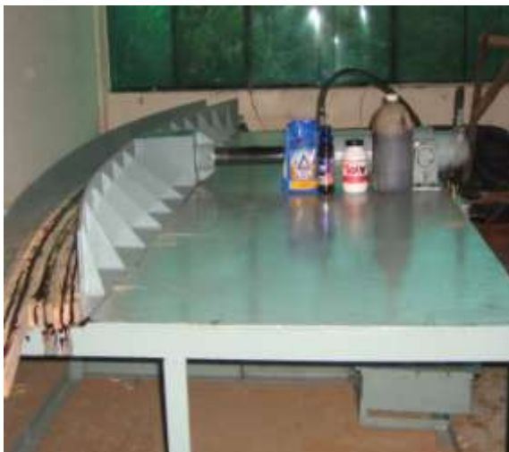
Gambar 9. Alat Curved-press hasil perbaikan dalam uji coba pembuatan glulam lengkung
