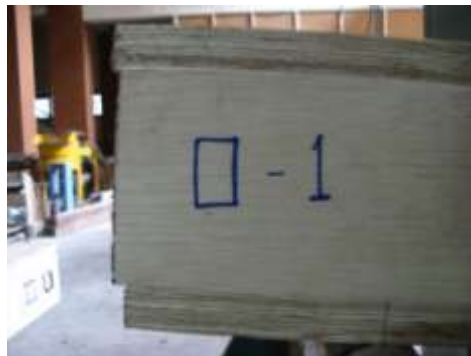
Gambar 6. Pergeseran sayap balok LVL kayu sengon
