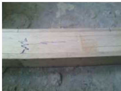
Gambar 5. Kegagalan struktur pada badan balok LVL kayu sengon
