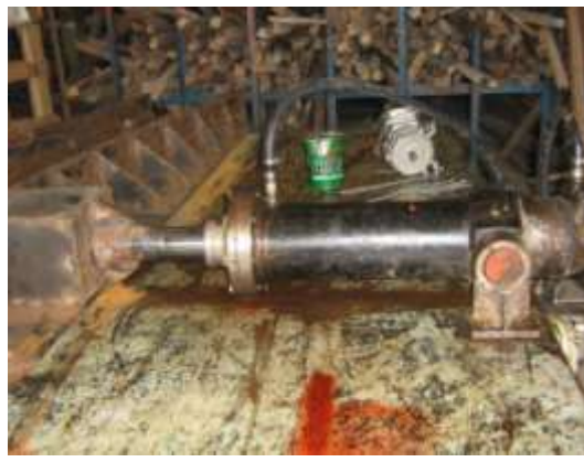
(d) Cylinder Hydrolic berfungsi menekan matress
