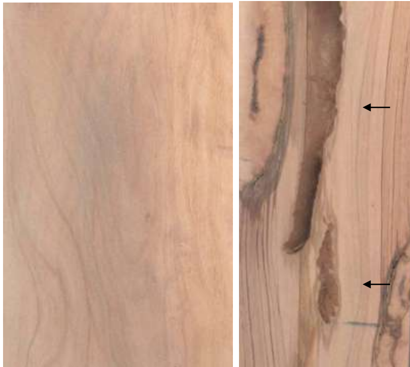
Gambar 2. Penampang longitudinal kayu S. benzoin . Kerusakan akibat penyadapan
