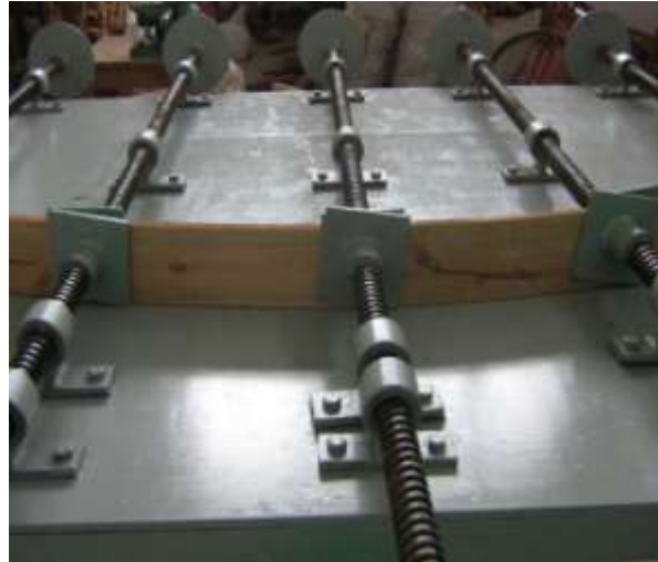
Gambar 7. Detail kerja draad pengencang
