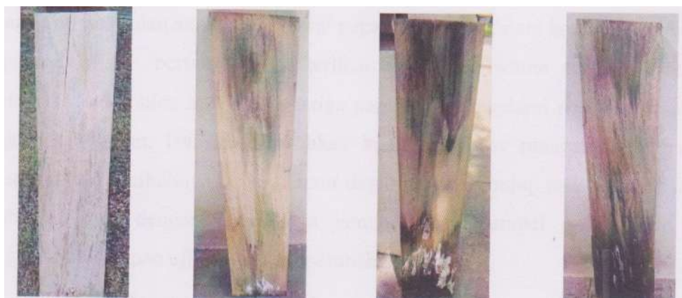
Gambar 3. Kondisi papan uji kayu jabon setelah 0, 1, 2, dan 3 bulan pemaparan di luar ruangan
