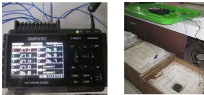
Gambar 1. Pengukuran suhu hidrasi menggunakan termokopel dan Graphtec midi LOGGER GL220
