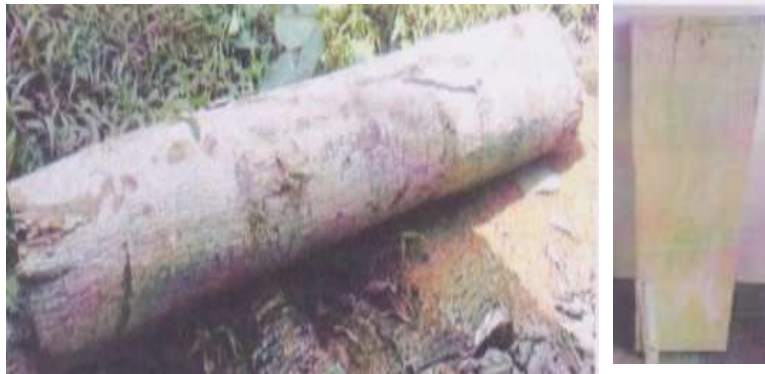
Gambar 1. Log kayu jabon sebelum digergaji (a) dan papan uji kayu jabon (b)
