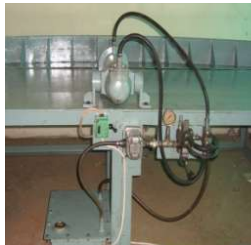
Gambar 10. Komponen kempa bertekanan 200 kg/cm 2
