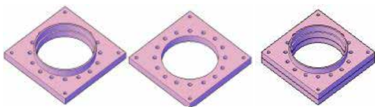
Gambar 20. Penggabungan komponen braket bawah antara bagian atas dan tengah
