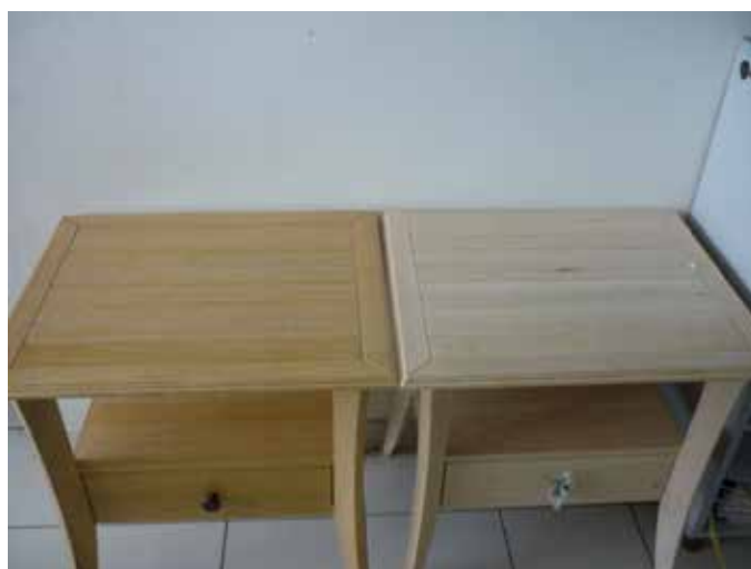
Gambar 2. Tabel terro dari kayu tengkawang ( Shorea macrophylla ) dengan perlakuan finishing (kiri) dan tanpa finishing (kanan).
